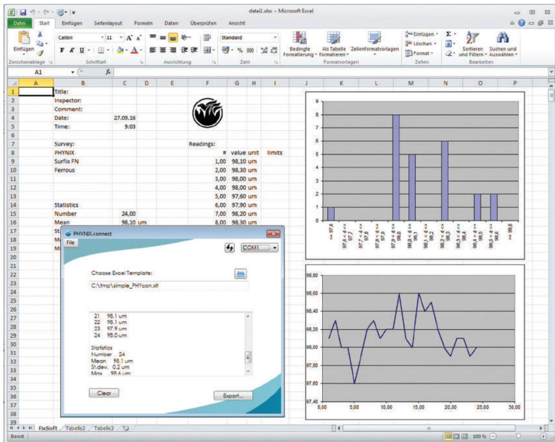
PHYNIX, Connect는 피닉스사의 코팅두께측정기용 데이터 전송프로그램입니다. 측정값은 미리 컴파일된 템플릿(측정값의 통합을 위한 패턴)에서 히스토그램 및 추세 프레젠테이션과 함께 Excel로 전송됩니다. 그리고 나중에 특정 고객 데이터를 추가할 수도 있습니다. (예 : 날짜, 일괄처리정보, 회사이름, 테스트한 사람 등) PHYNIX, Connect는 무료로 다운로드하여 사용할 수 있습니다.
